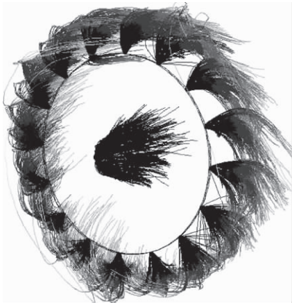
图 4 TAPS/MLDI 燃烧室燃油喷射方式
